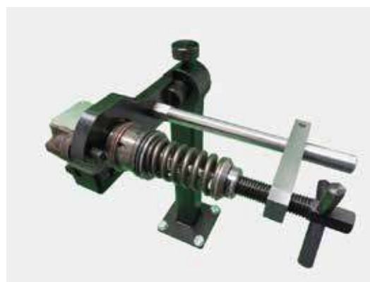
Установка в струбцине насосной секции DAF Bosch 0414755005
