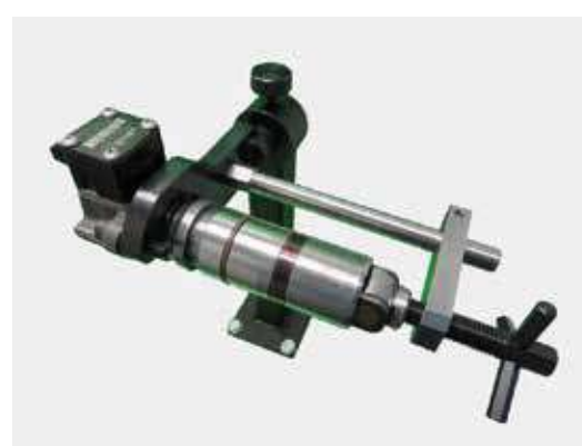
Установка в струбцине насосной секции MB ACTROS
