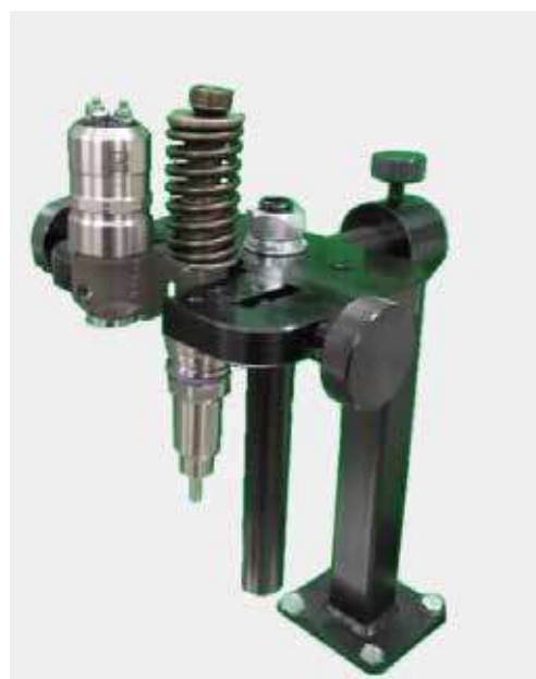
Установка в струбцине насос-форсунки SCANIA Ч-образной
