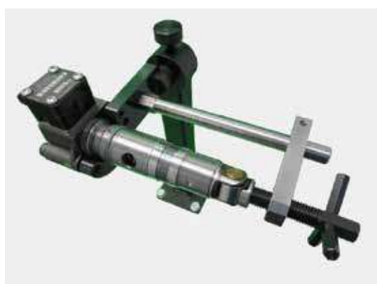
Установка в струбцине насосной секции MB ATEGO
