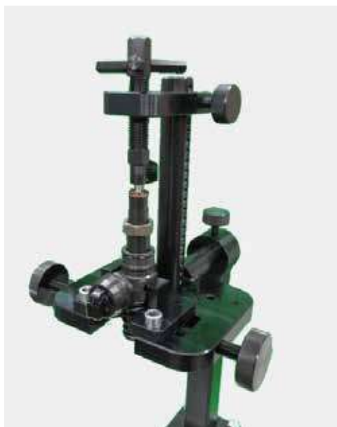
Установка в струбцине насос-форсунки AUDI / VW 1.9
