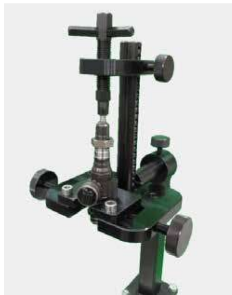
Установка в струбцине насос-форсунки SCANIA Ч-образной
