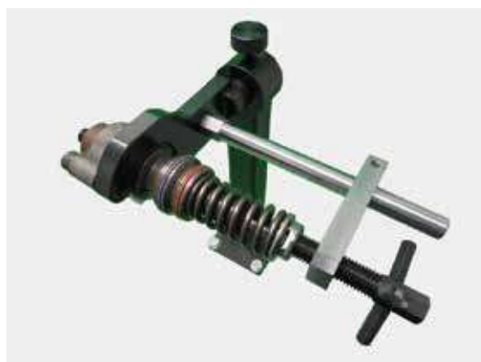
Установка в струбцине насосной секции Delphi 082240354
