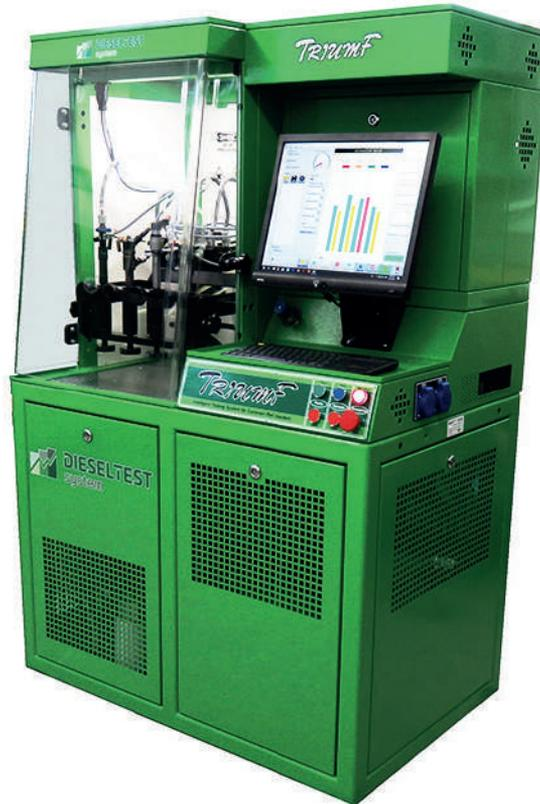
Диагностический стенд **TRIUMF** предназначен для проверки форсунок CommonRail производства Bosch, Delphi, Denso, Siemens при системном давлении до 2400 бар. Измерение происходит с помощью электронной системы измерения. Программно-аппаратный комплекс для кодирования форсунок Bosch, Delphi, Denso **не входит в комплект поставки**.
