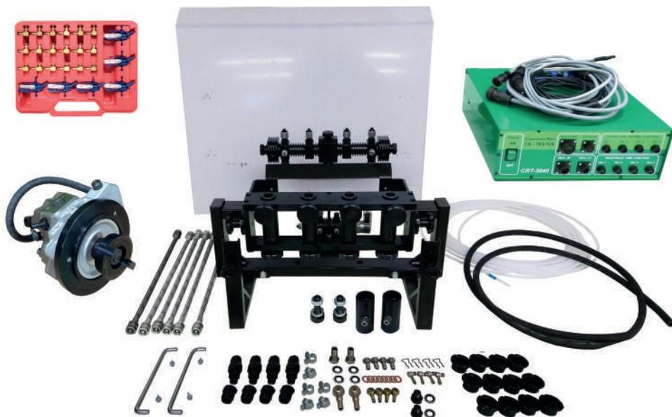
Комплект базовой оснастки предназначен для проверки форсунок Common Rail различных производителей (Bosch, Denso, Delphi, VDO (Siemens) Cummins, Caterpillar, AZPI).
